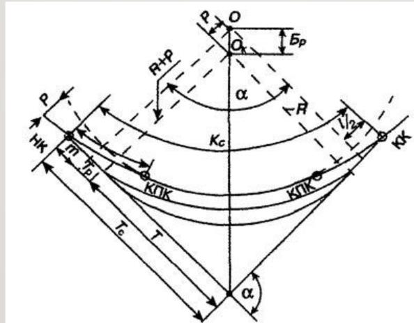
Рис. 3.88. Размещение переходной кривой на плане: НК и КК – точки сопряжения переходной кривой с прямой; КПК – точка сопряжения переходной кривой с кривой радиуса  $R$  (остальные обозначения – см. текст)
