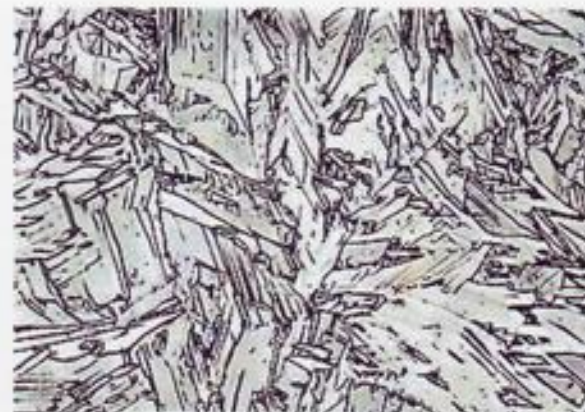
После быстрого охлаждения x300
