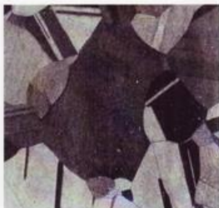
Структура однофазной латуни
