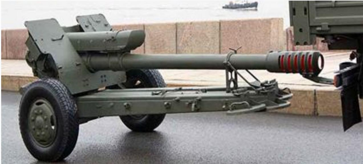
Рисунок 1.8 – Фото гаубицы Д-30 в походном положении
