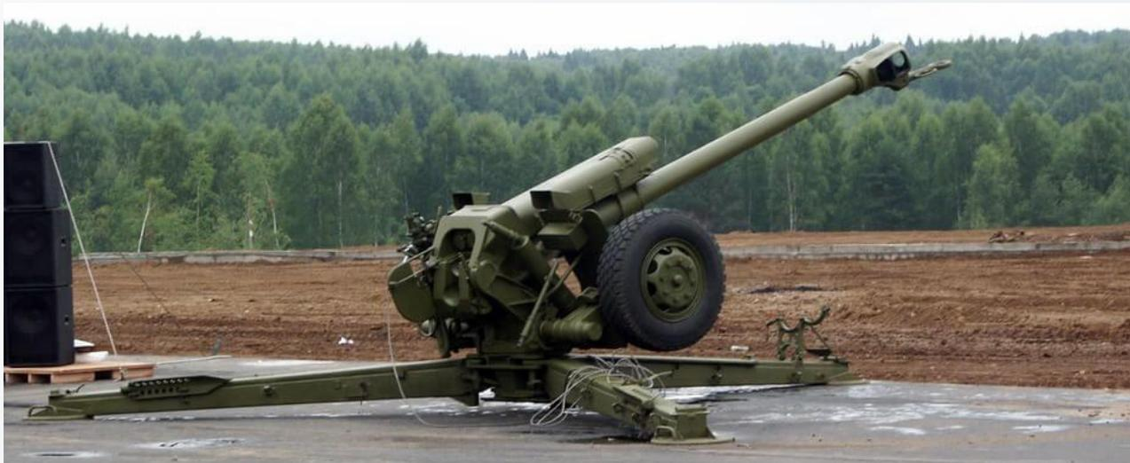
Рисунок 1.9 – Фото гаубицы Д-30 в боевом положении
