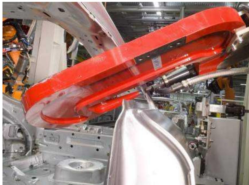
Использование соединения штамповочными заклёпками в производстве
