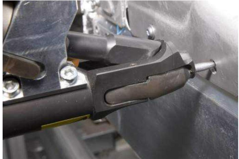
Процесс соединения винтами Flow-Drill на производстве
