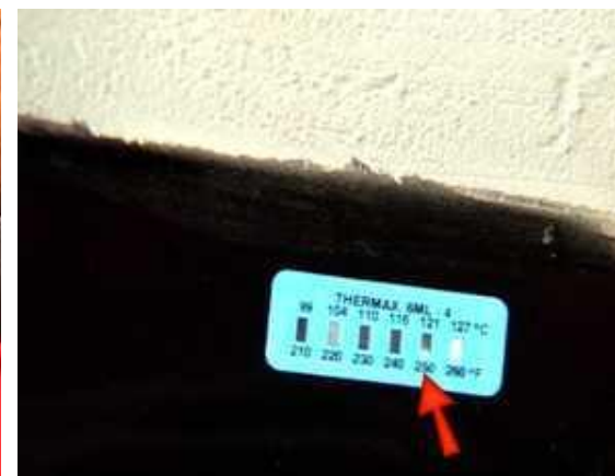
Выдерживание температуры в зависимости от толщины слоя шпатлёвки
