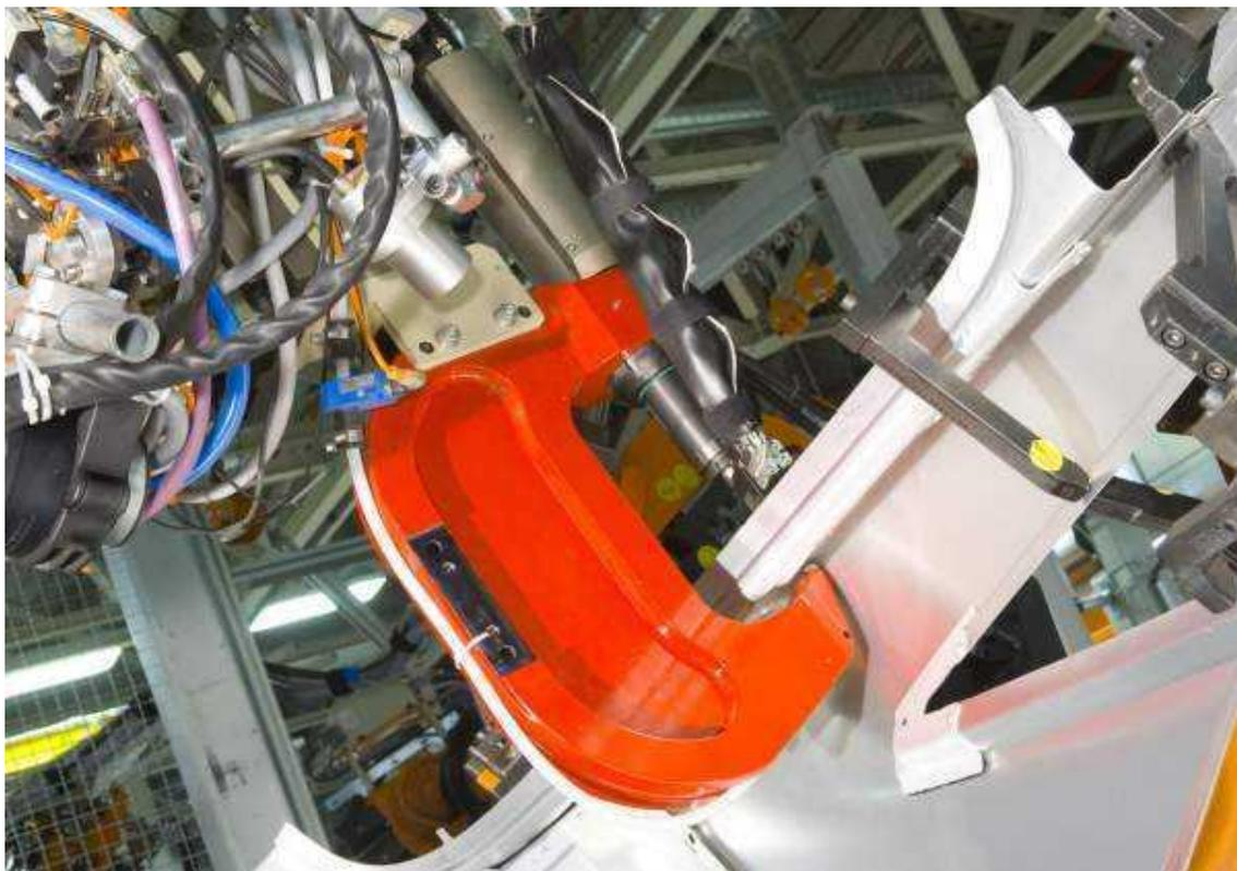
Процесс соединения деталей самопробивными заклёпками на производстве
