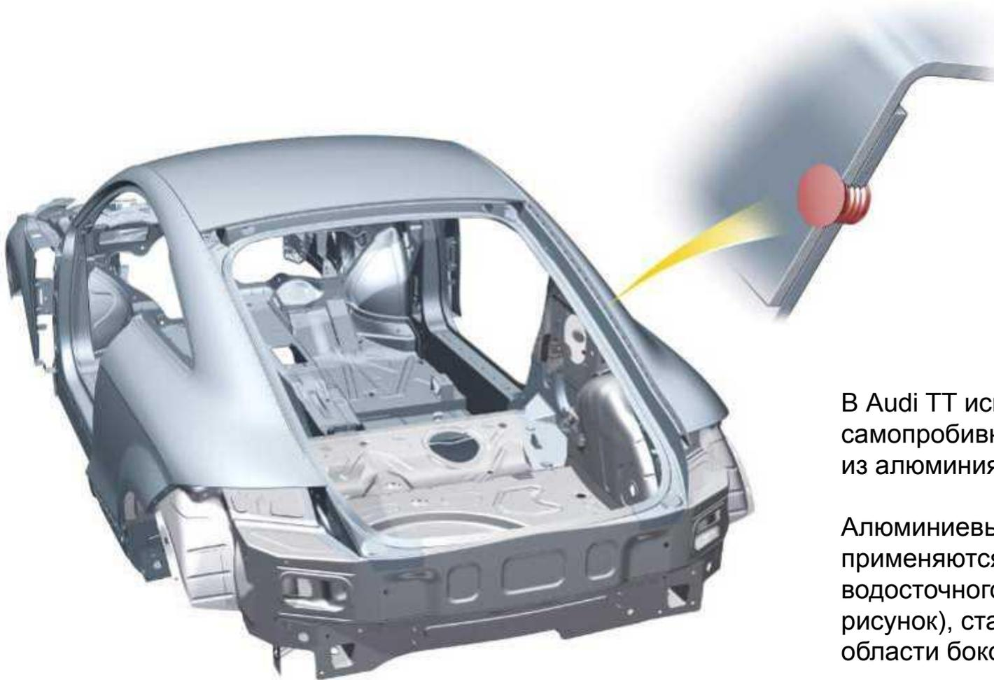
В Audi TT используются самопробивные заклёпки как из алюминия, так и из стали.
