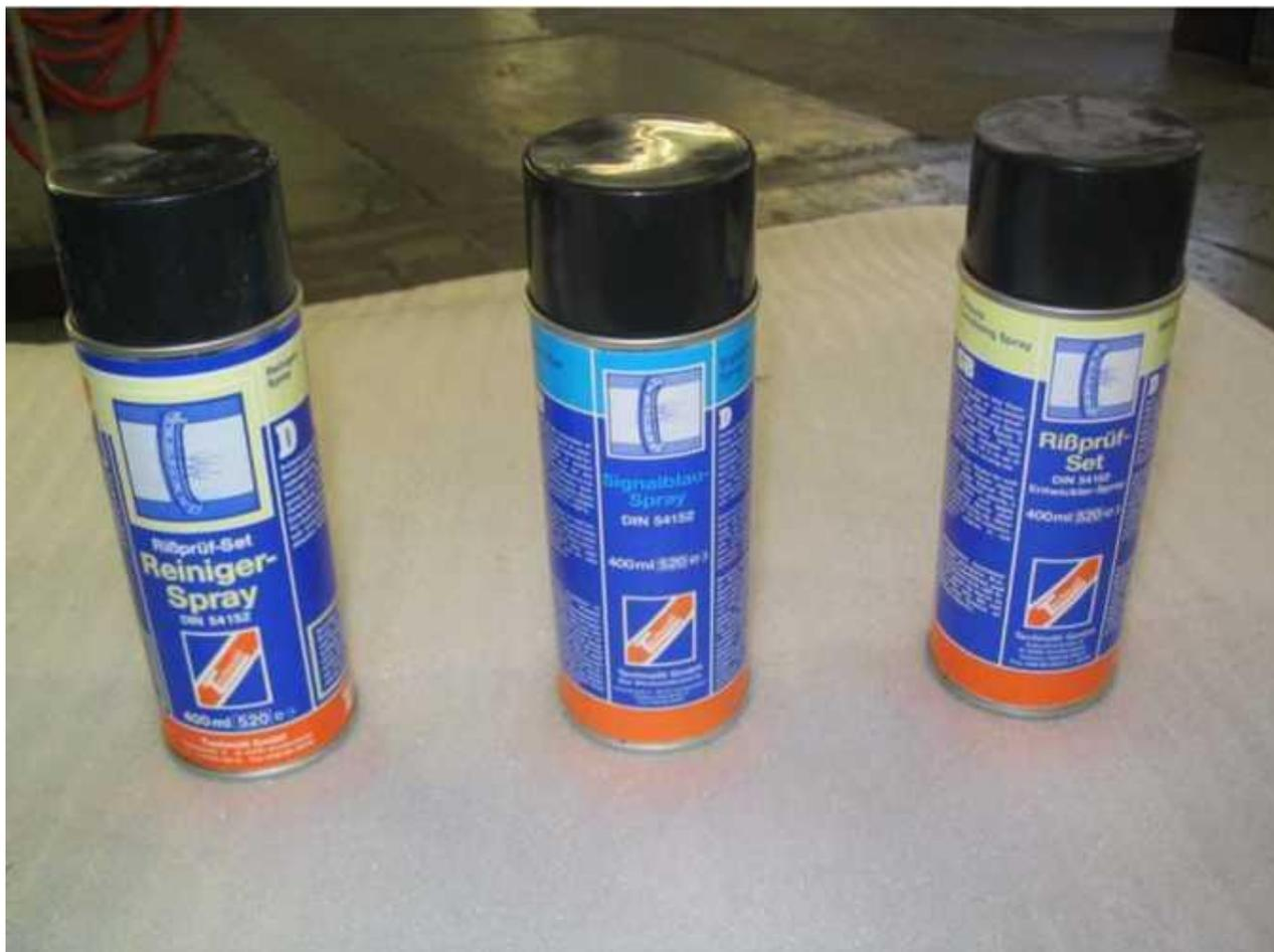
Набор для контроля трещин V.A.G. 2014
