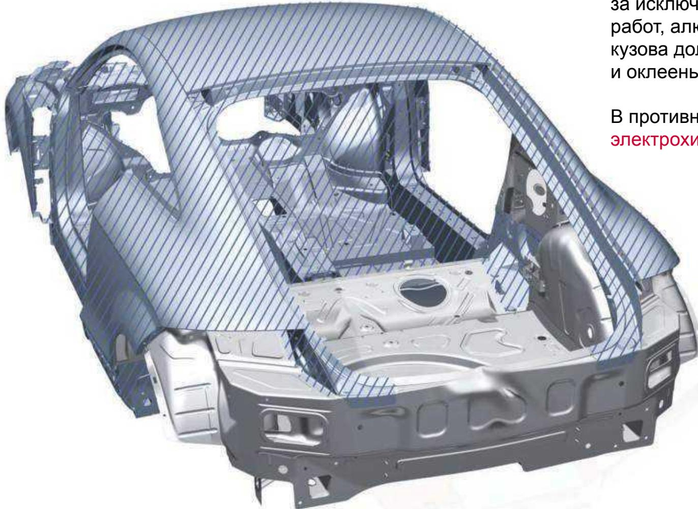
При кузовных работах со стальными деталями кузова, за исключением рихтовочных работ, алюминиевые детали кузова должны быть закрыты и оклеены!
