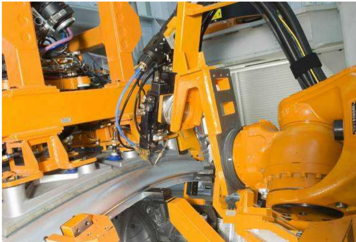
Лазерная сварка крыши и боковины на производстве
