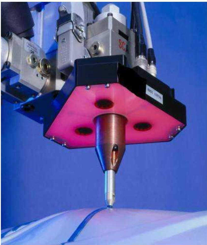
На производстве нанесение клея для структурного склеивания полностью автоматизировано и осуществляется под видеоконтролем.
