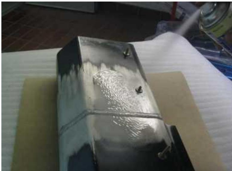
Нанести проявитель и проверить отсутствие трещин
