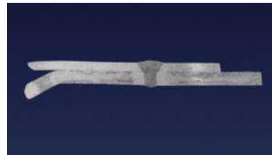
Лазерная сварка на производстве
