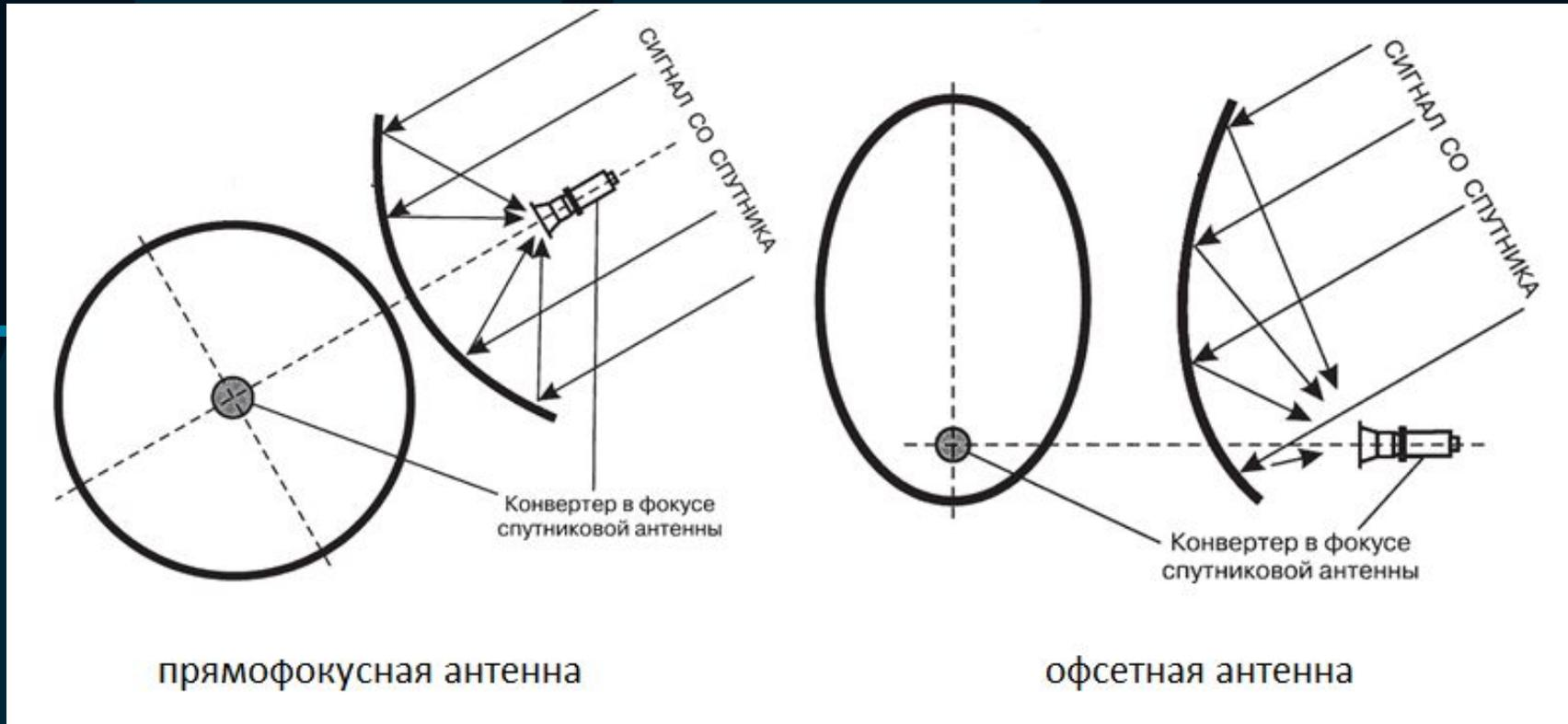
предназначена для приема и концентрации электромагнитных волн, исходящих со спутника-ретранслятора на облучатель.
