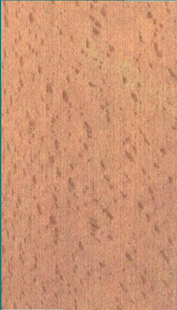
Древесина бука с красивой крапчатой текстурой от возраста имеет различную окраску. Бук – материал плотный, твердый, легко поддается обработке, хорошо гнется. Из бука изготавливают: гнутую мебель, строганный шпон, музыкальные инструменты.
