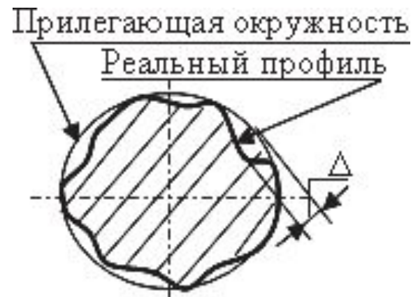
Рисунок 8 – Отклонение от круглости
