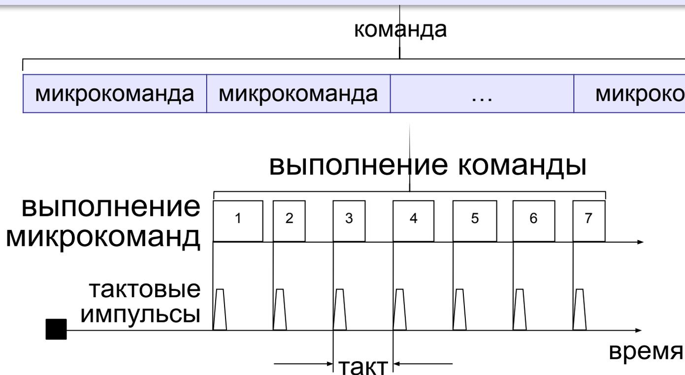
генератор тактовых импульсов
