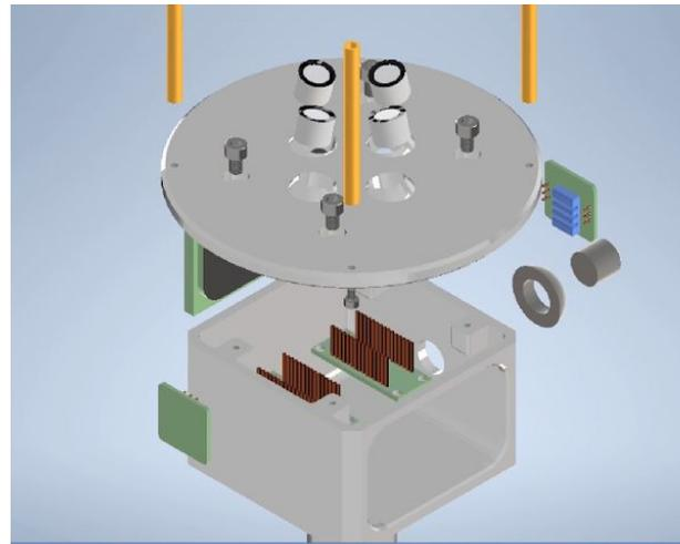
*Внутренняя конфигурация корпуса анемометра*
