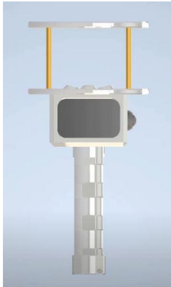
Разработанная модель анемометра из алюминиевого сплава с защитным покрытием
