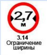
применяют для запрещения движения ТС, **габаритная ширина** которых (с грузом или без груза) больше указанной на знаке.
