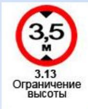
применяют для запрещения движения ТС, **габаритная высота** которых (с грузом или без груза) больше указанной на знаке.
