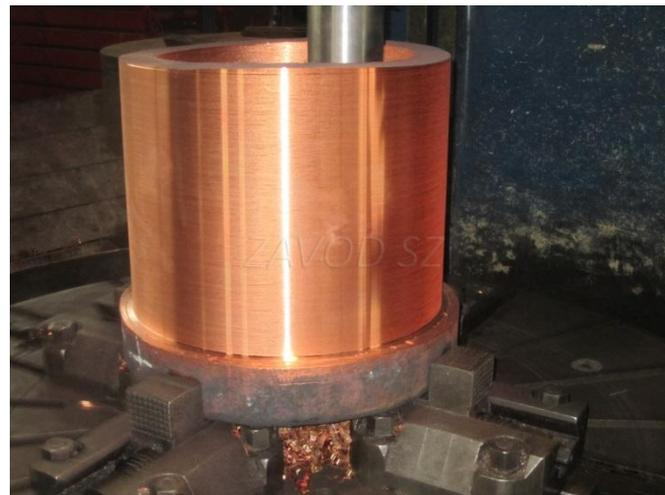
Спецификой токарно-карусельных станков является токарная обработка деталей большого диаметра и веса, обладающих небольшой высотой. Горизонтальное расположение стола позволяет производить выверку и установку детали в планшайбу с наименьшими усилиями. Отсутствиие изгибающих сил при вертикальном расположении детали положительно сказывается на точности обработки.
