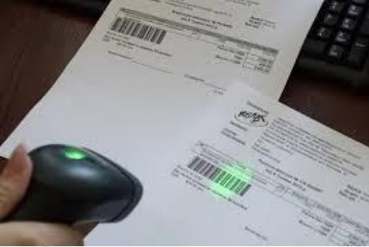
Чтобы считать информацию содержащуюся в штрих коде, сканирующее устройство, например, сканер "палочка", движется через штрих код от одного края к другому. Во время движения устройства через штрих код, ширина штрихов и пробелов анализируется декодером и первоначально закодированные данные восстанавливаются в формате воспринимаемом программным обеспечением.
