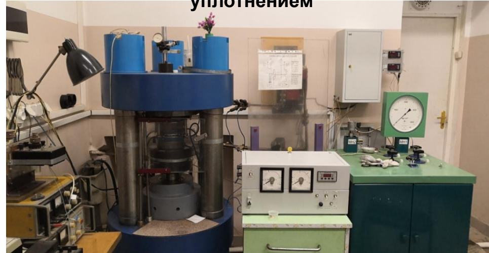
Установка высокого давления «наковальня с лункой» (НЛ-13Т) с тороидальным уплотнением
