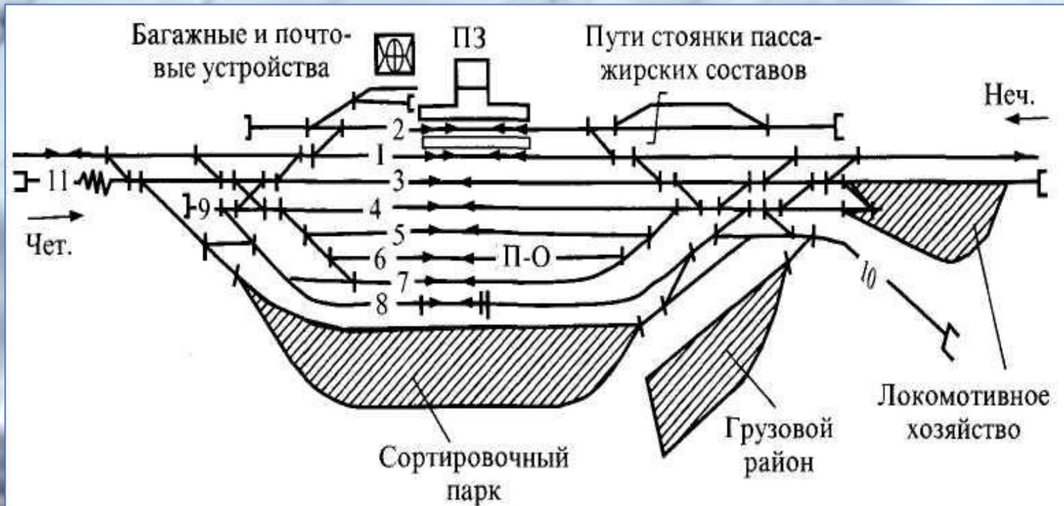
Рис. 4.3. Немасштабная схема участковой станции однопутной линии
