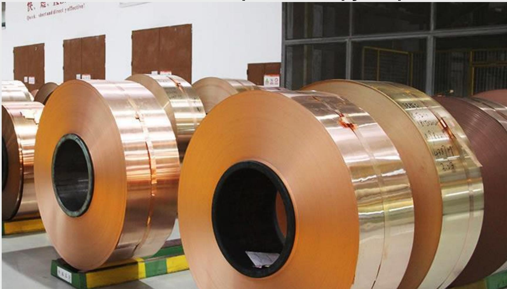
**Бериллиевые бронзы (1,8—2,3% Be)** способны при быстром охлаждении с **800°** принимать закалку и становятся твердыми и упругими, как сталь. Их применяют главным образом при изготовлении часовых механизмов и в точной механике.
