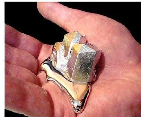
Легкоплавкие сплавы производят из **висмута, свинца, кадмия, олова** и других металлов. Такие сплавы используют в термодатчиках, термометрах, пожарной сигнализации, например, сплав Вуда.
