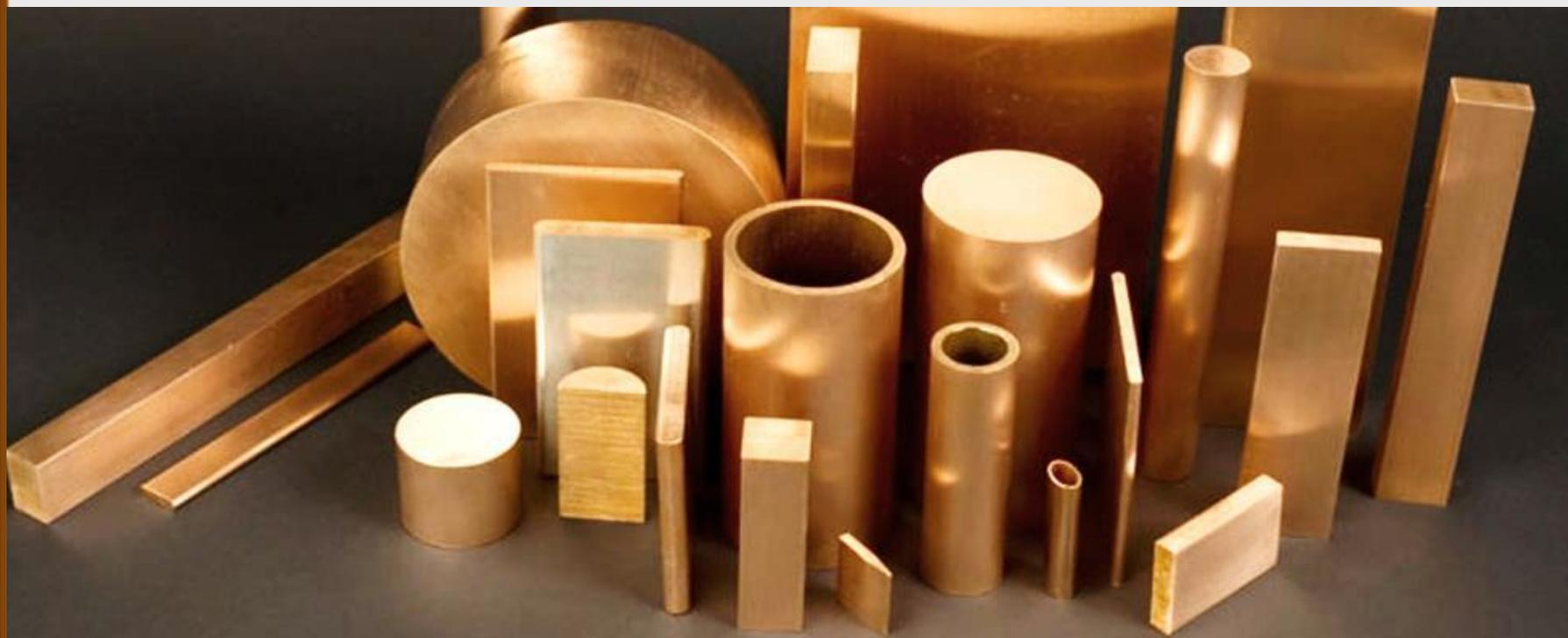
Сплавы меди, содержащие до **10%** цинка, называются томпаком; при большем содержании цинка (**10—40%**) — латунью. Томпак и латунь хорошо прокатываются и обрабатываются штамповкой и прессованием. Они применяются для изготовления листов, труб, патронных гильз и различной арматуры (краны, вент
