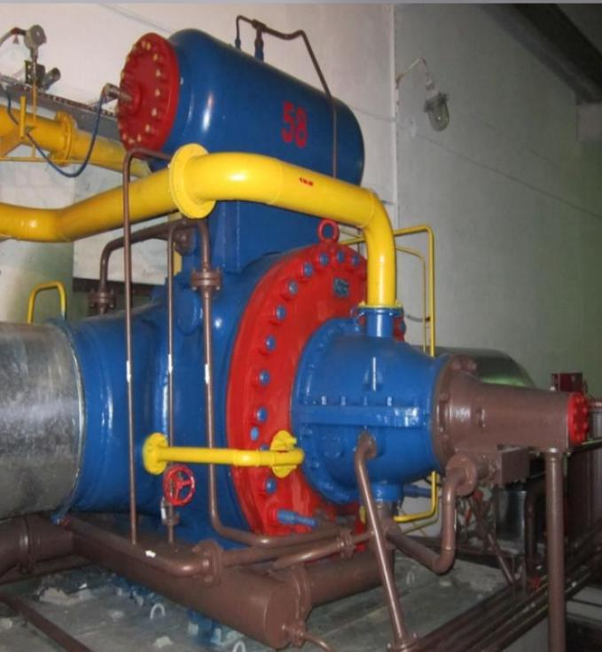
Предназначен для сжатия, транспортировке по магистральному газопроводу. Работа возможна по схеме одного нагнетателя или параллельная работа нескольких одинаковых нагнетателей.
