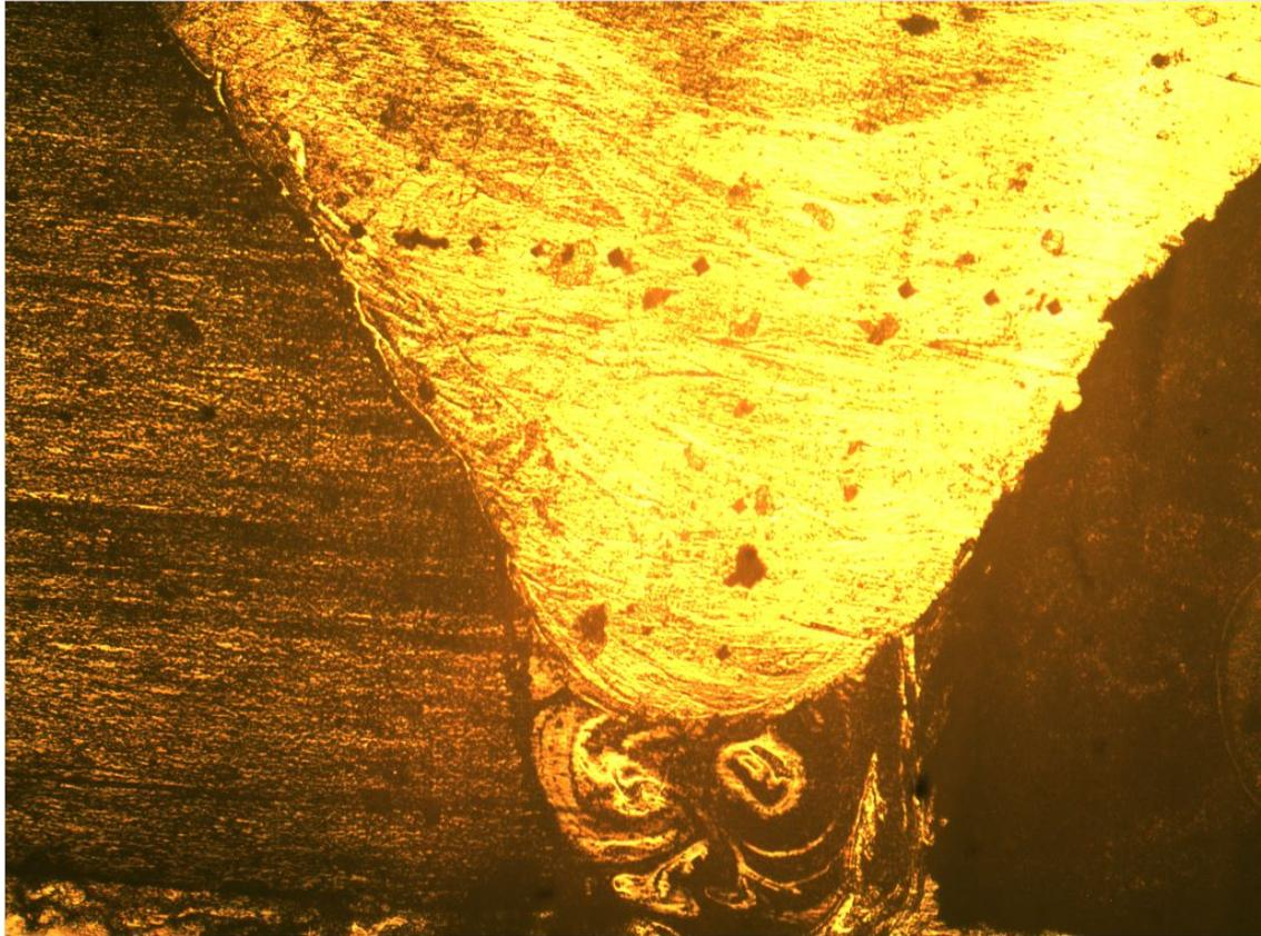
Дефектов нет. Металл толщиной 1мм полностью проплавлен. Корень шва формируется на подкладке.
