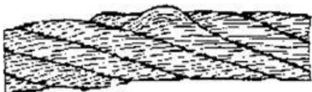
в) выдавливание проволок в одной пряди
