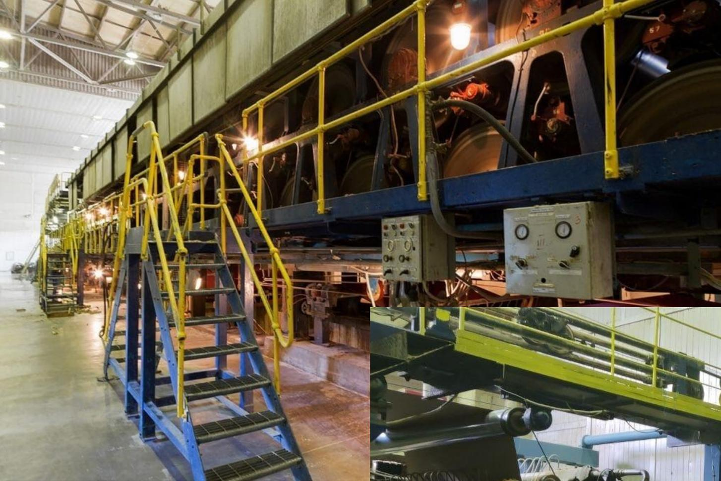
Машина, доставленная из Англии, состояла из сеточной, прессовой и сушильной частей.
