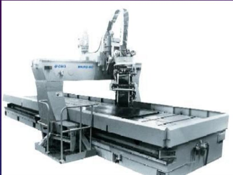
Предназначен для изготовления плоских заготовок деталей из полимерных композиционных материалов методом автоматизированной выкладки на соответствующие формы. Выкладка производится предварительно пропитанным и подсушенными материалами - препрегами. Станок имеет 5 управляемых координат.
