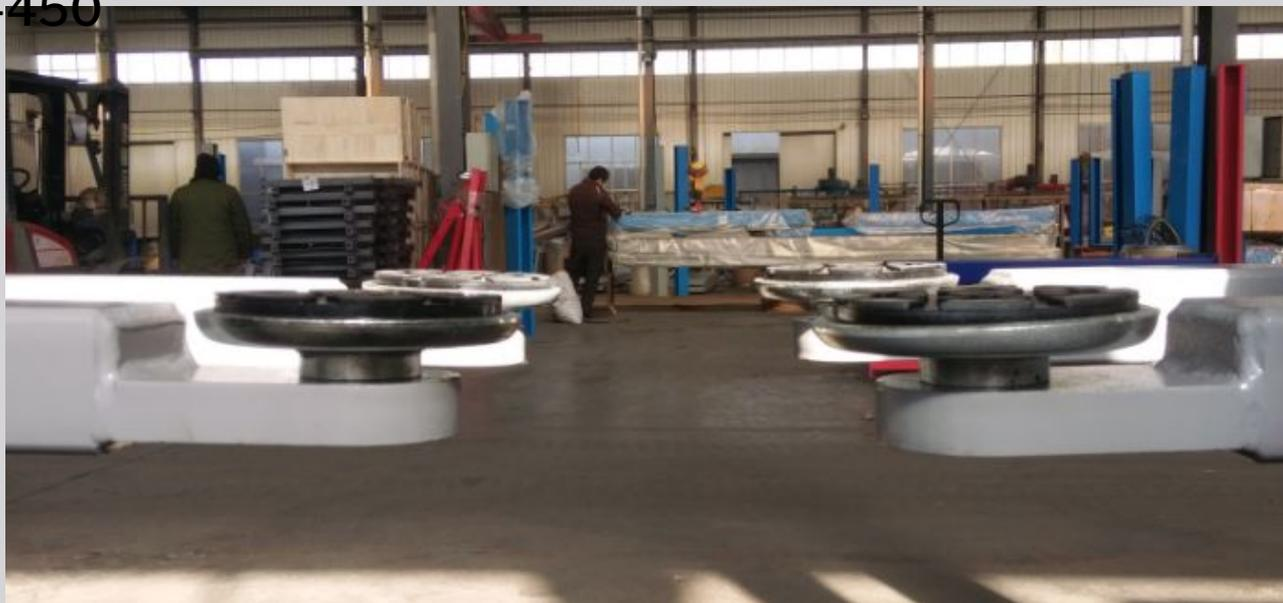
Все лапы находятся в одной плоскости, что обеспечивает безопасный подъем автомобилей. И свидетельствует о качестве сборки и точности сварки
