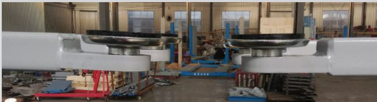
Контроль Плоскости подхватов (говорит о точности сварки)
