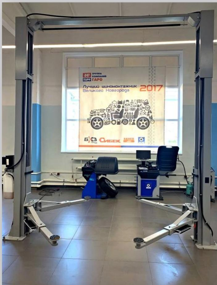
RLP2-450 – грузоподъемность 4,5 тонны, электрогидравлический подъемник **с нижней** синхронизацией, симметричная конструкция лап\*
