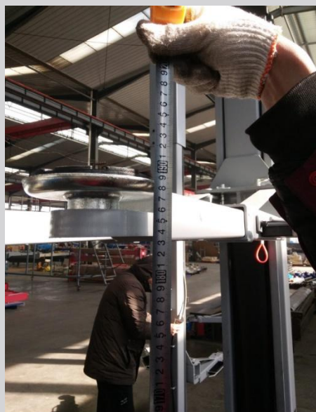
Контроль заявленных минимальной высоты подхвата и максимальной высоты подъема.
