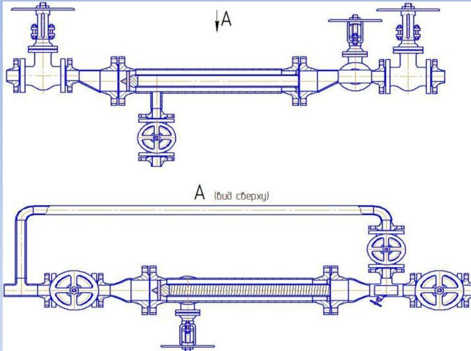
Схема монтажа наземного фильтра ФН-I-168x8,9-2000x1 с опцией обратной промывки.
