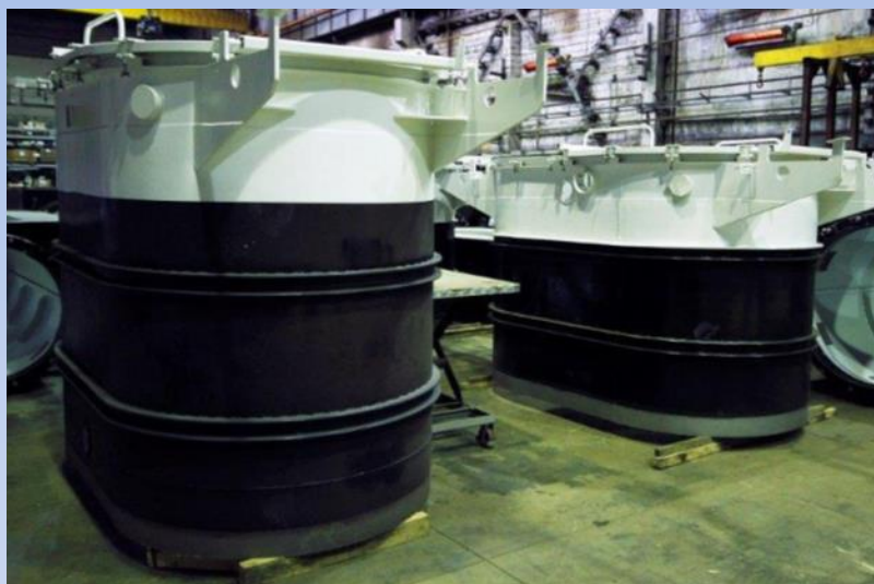
Колодец для подземного укрытия патрубка вантуза КВГ
