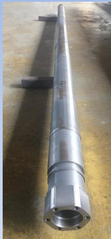
**Назначение:** используется в составе УЭЦН 4÷8 габаритов для защиты рабочих органов насоса от износа механическими примесями.
