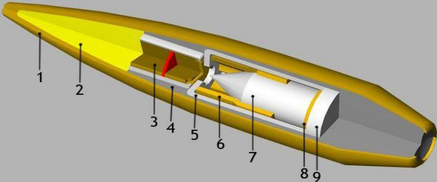
1 - оболочка; 2 - зажигательный состав; 3 - капсюль-воспламенитель KB-11; 4 - свинцовая рубашка; 5 - стаканчик; 6 - центробежно-инерциальный предохранитель; 7 - ударник; 8 - латунный кружок; 9 - железная прокладка.
