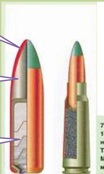
7,62-мм патрон образца 1943 г. с модернизированной трассирующей пулей Т-45М (индекс 57-Т-231ГМ1). Масса патрона – 15,8 г, масса пули – 7,5 г, длина пули – 28,0 мм, начальная скорость – 710 – 725 м/с
