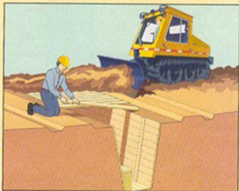
Оборудование перекрытой щели
