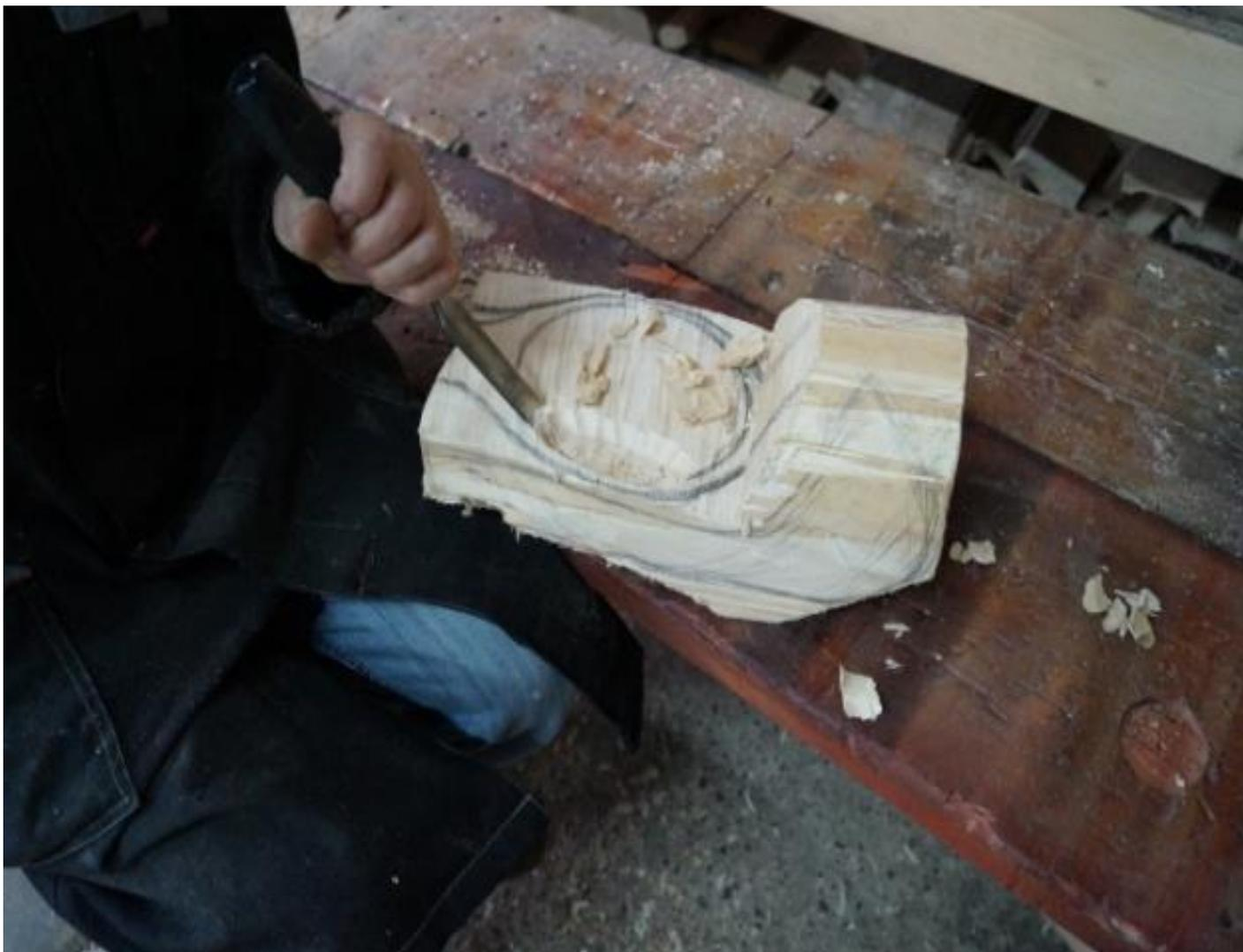
*По верхнему наружному краю изготавливаем картонный шаблон и выпиливаем крышку*
