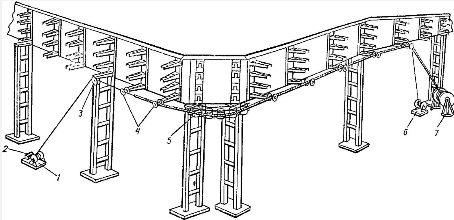
Комплекс приспособлений и механизмов КПЭ для прокладки кабелей по открытым эстакадам: 1 — тяговая лебедка; 2 — устройство для контроля усилий тяжения; 3 — монтажный ролик МР-250; 4 — линейные ролики РЛУ; 5 — универсальное обводное устройство; 6 — вспомогательная лебедка; 7 — безосевые кабельные домкраты
