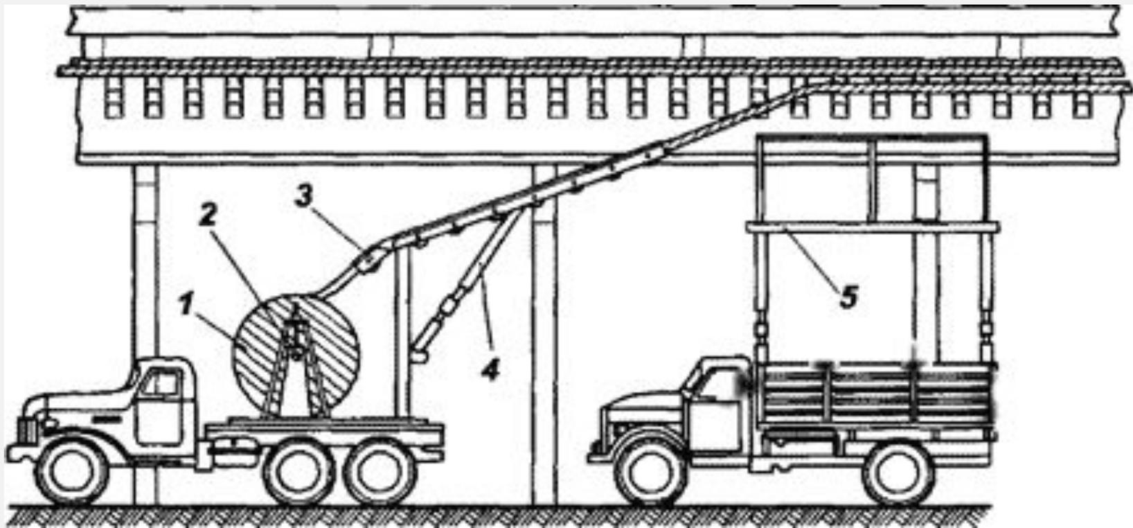
Прокладка кабеля по открытой эстакаде с помощью специально оборудованного автомобиля и манипулятора: 1 — домкраты с механизмом подъема кабельного барабана; 2 — механизм вращения кабельного барабана; 3 — валковое протяжное приводное устройство; 4 — винтовое упорное устройство для регулирования высоты подъема кабеля; 5 — платформа для размещения монтажников при укладке кабеля
