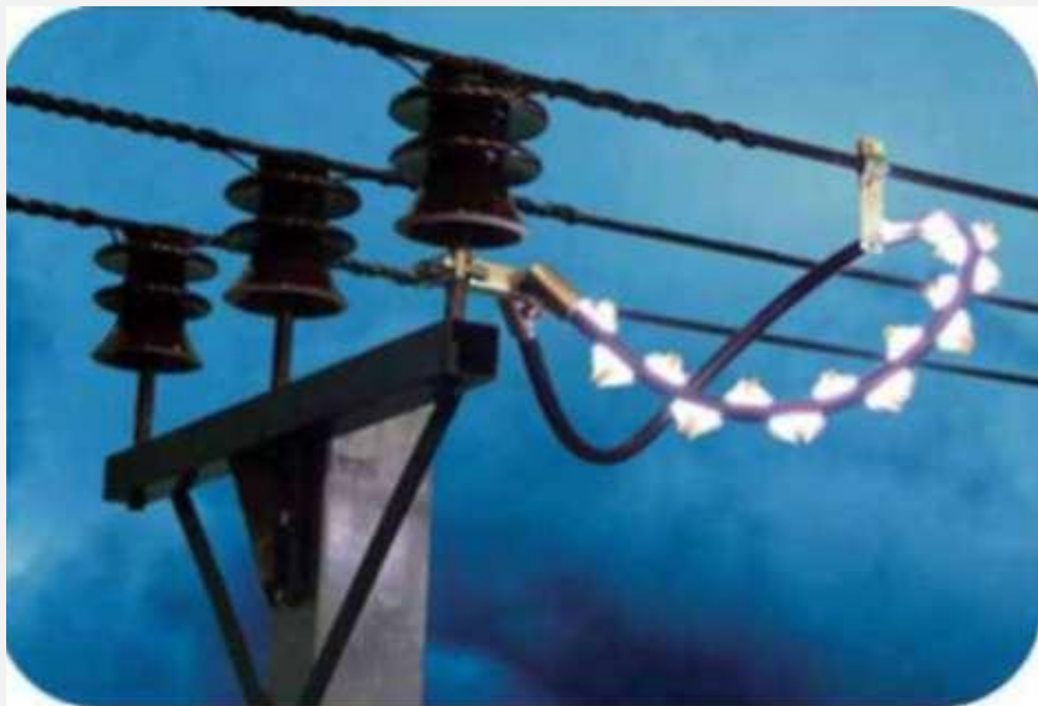
б) фотография испытаний на макете.
