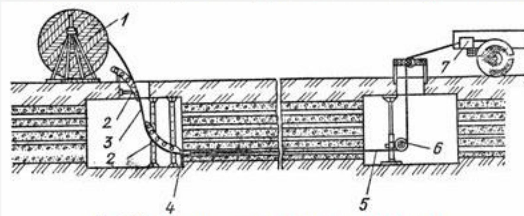
Схема протяжки кабеля в кабельном блоке:
