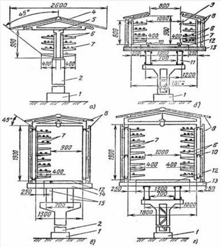
*а* – эстакада непроходная; *б* – эстакада проходная; *в* – галерея односторонняя; *г* – галерея двусторонняя;
