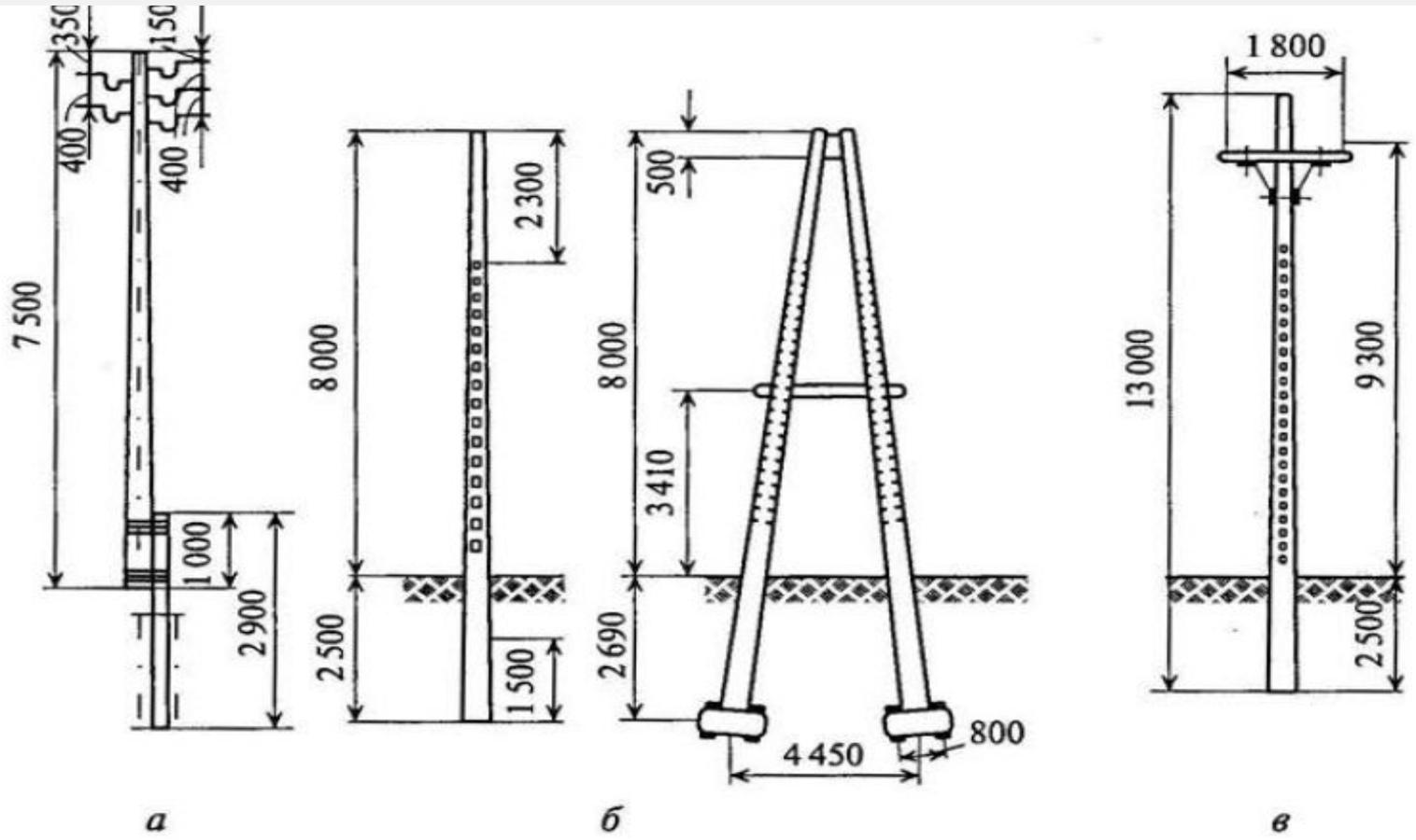
Рис. 4.6. Опоры воздушных линий:
