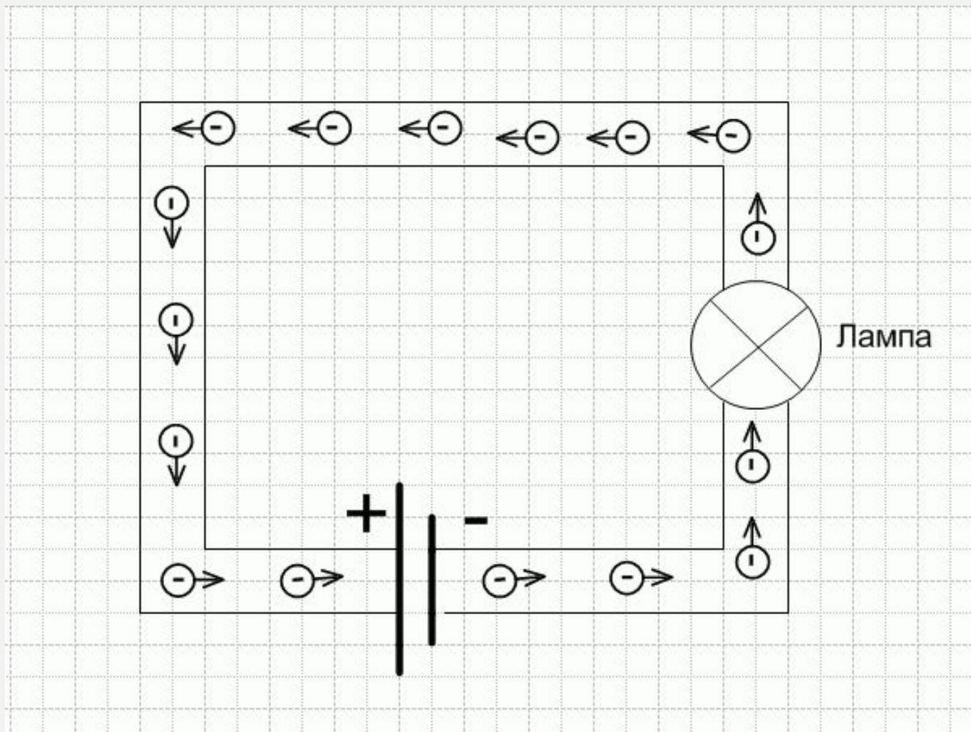
Электрический ток в проводниках - это направленный поток свободных электронов.
