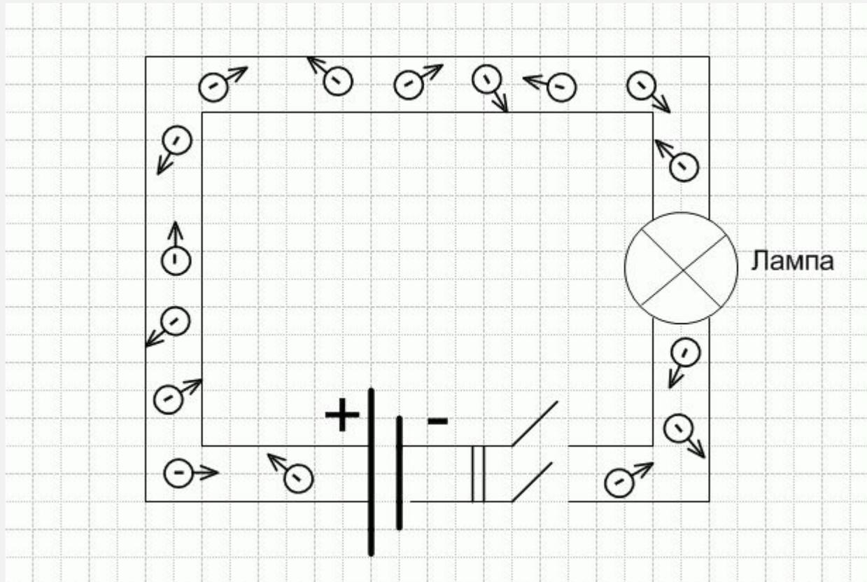
Замкнем электрическую цепь. Источник тока образует в электрической цепи электрическое поле которое взаимодействует с электрическими полями каждого электрона. В результате свободные электроны будут двигаться в одном направлении.
