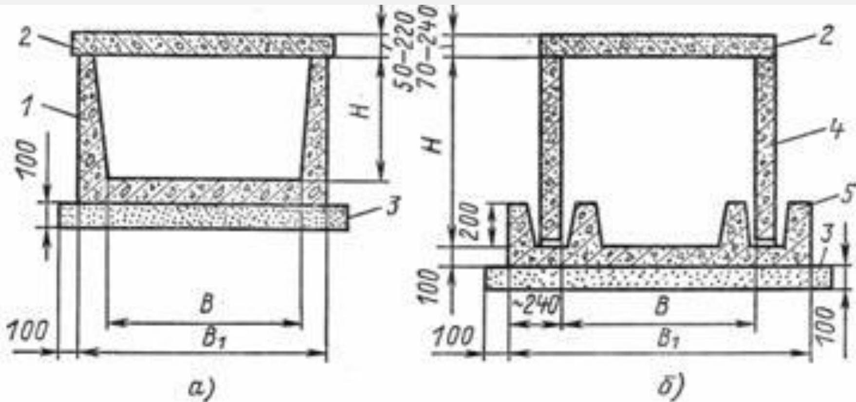
Сборные железобетонные каналы:
