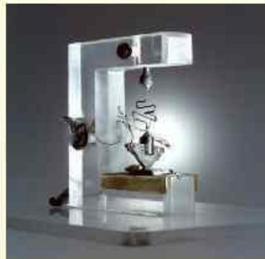
Лосев в 1923 г. на карборундовом детекторе обнаружил холодное безинерционное свечение, т.е. способность полупроводников генерировать электромагнитные излучения в световом диапазоне волн.
