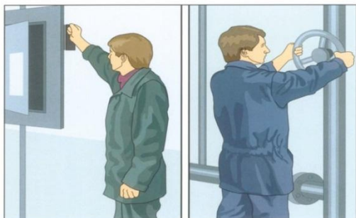
По команде руководителя остановить производство (оборудование) по схеме аварийного отключения. Отключить вентиляцию и электрооборудование. Перекрыть краны и задвижки на трубопроводах подачи газа, масла, агрессивных и горючих жидкостей. Открыть задвижки для их слива в аварийные ёмкости
