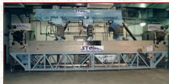
Трибоэлектростатический сепаратор Separation Technologies (США)
