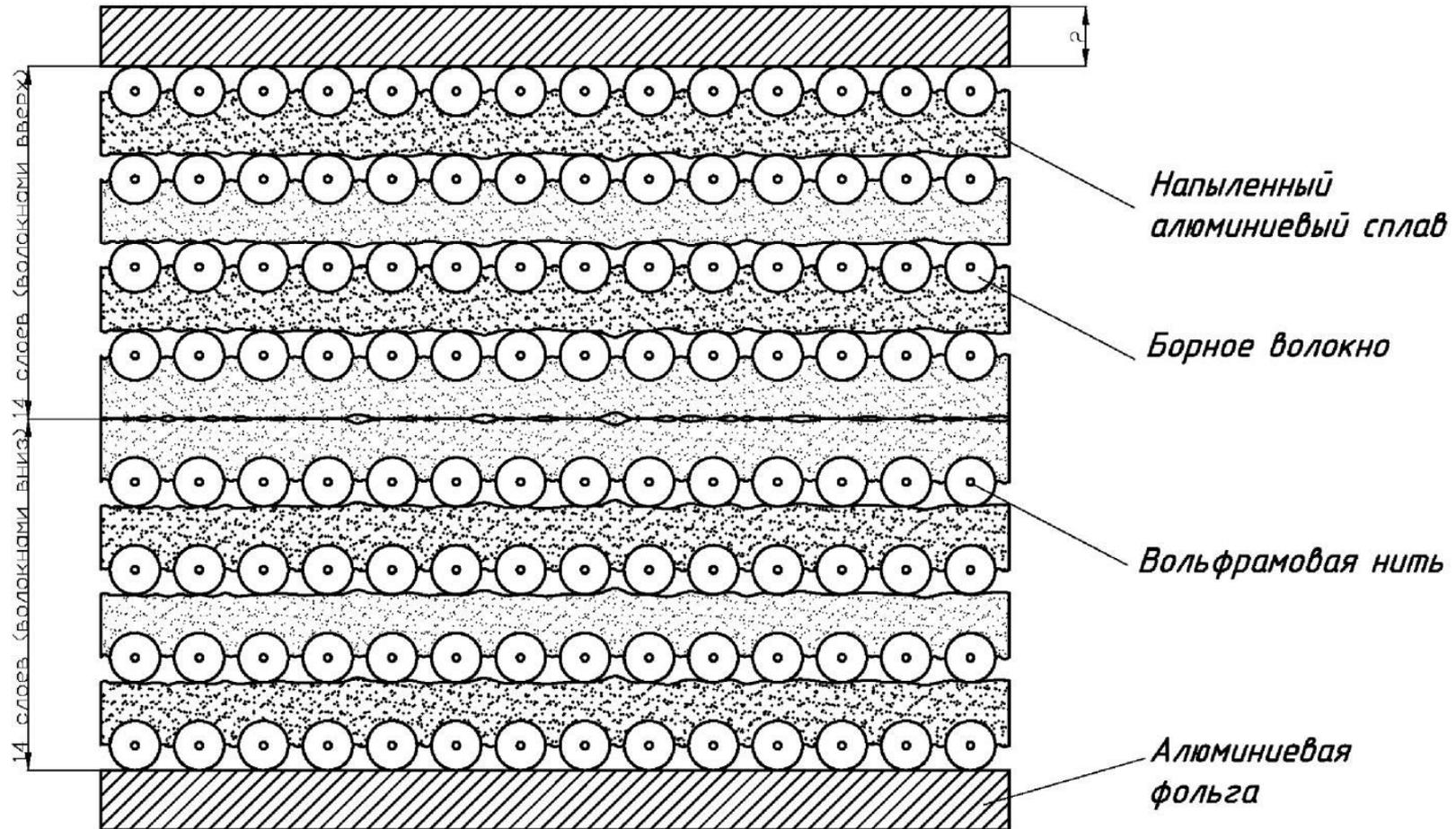
Рис. 4. - Схема сборки многослойной пакетной заготовки КМ на основе В-А1 шпона
