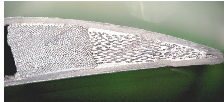
Рис. 9. - Формирование кромки пера лопатки с применением боралюминиевых стержней с поперечным армированием (ГНЦ ФГУП «ВИАМ», ГНЦ ФГУП «ЦИАМ»)
