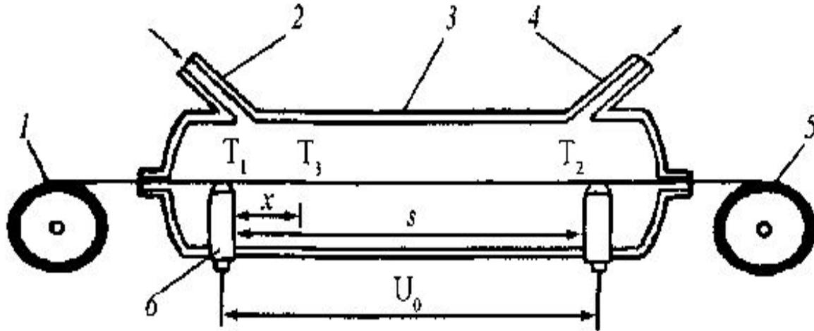
Рис. 1. - Схема реактора для получения борного волокна:
