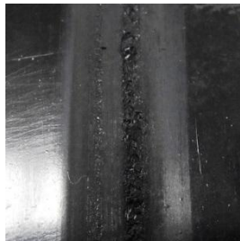
Повреждения в парах резина / металл
