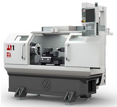
Токарный станок с ЧПУ HAAS TL – 1
