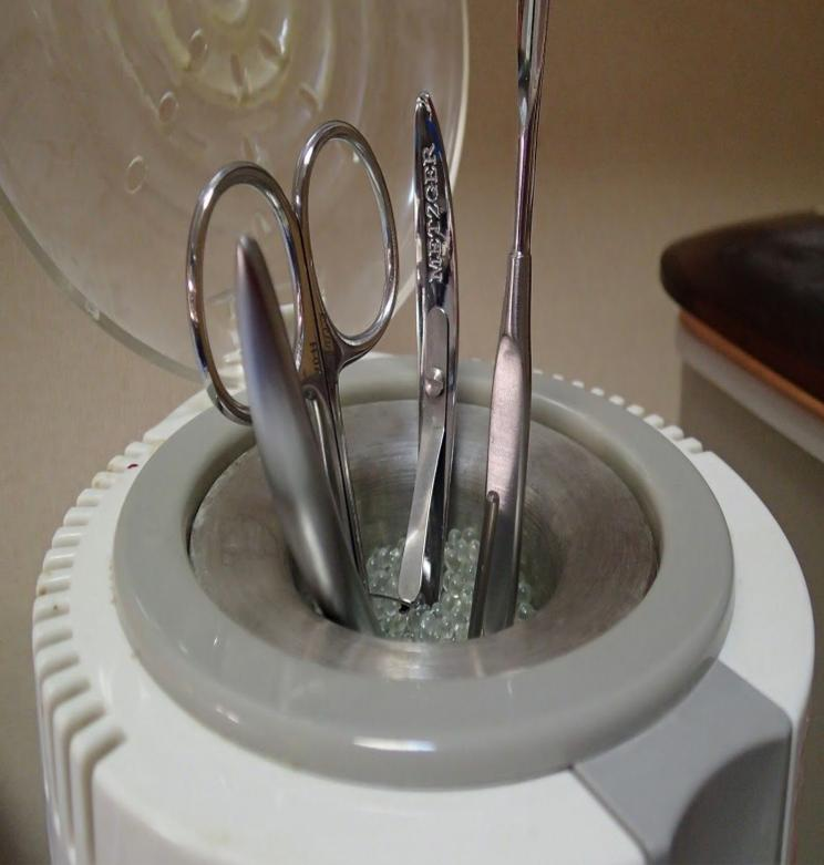
Принцип действия гласперленового стерилизатора основан на приведении стерилизуемых хирургических инструментов в контакт с маленькими стеклянными сферами, имеющими температуру 250С.
