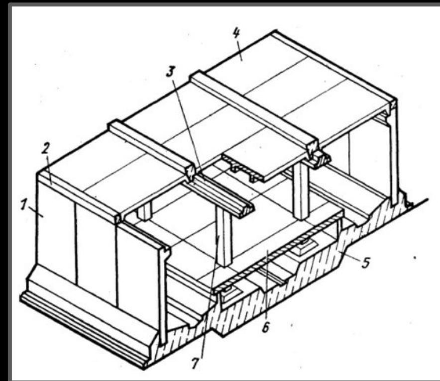
Конструкция трехпролетной колонной станции:
