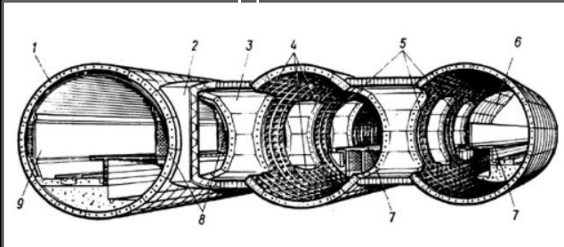
1 — нормальное тубинговое кольцо в глухой части станции; 2 — железобетонная обделка прохода; 3 — проход; 4 — клинчатая перемычка проемной части станции; 5 — пилон; 6 — водоотводящий зонт; 7 — платформа; 8 — обстройка пилонной части; 9 — путевая стена
