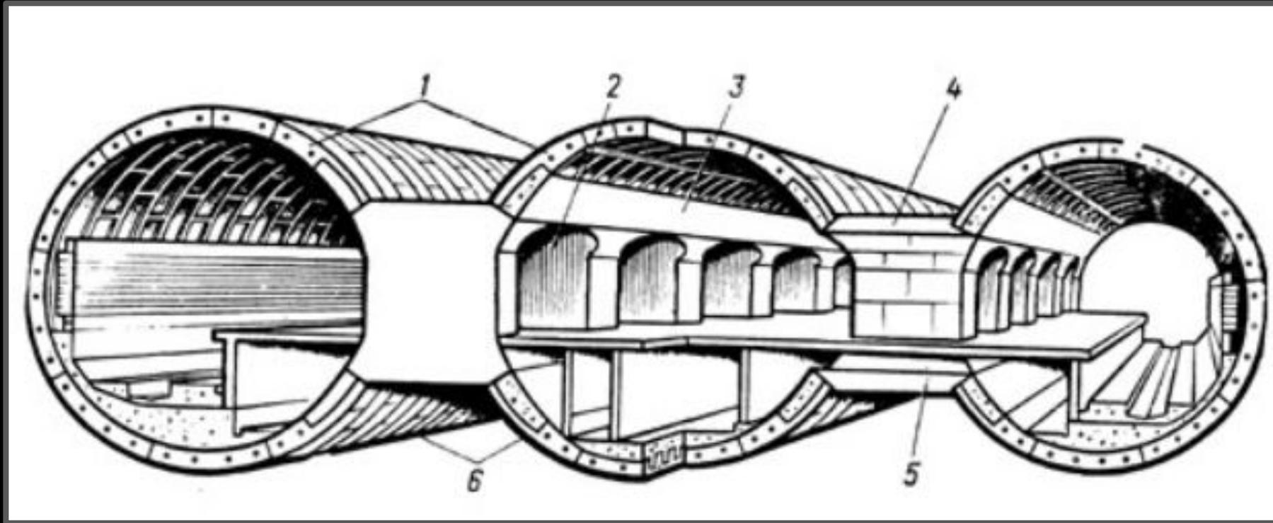
1 — верхний фасонный тубинг; 2 — проход из центрального зала к платформе; 3 — верхние монолитные железобетонные балки проема; 4 — бетонная обделка прохода, 5 — нижние железобетонные балки проема; 6 — нижний фасонный тубинг
