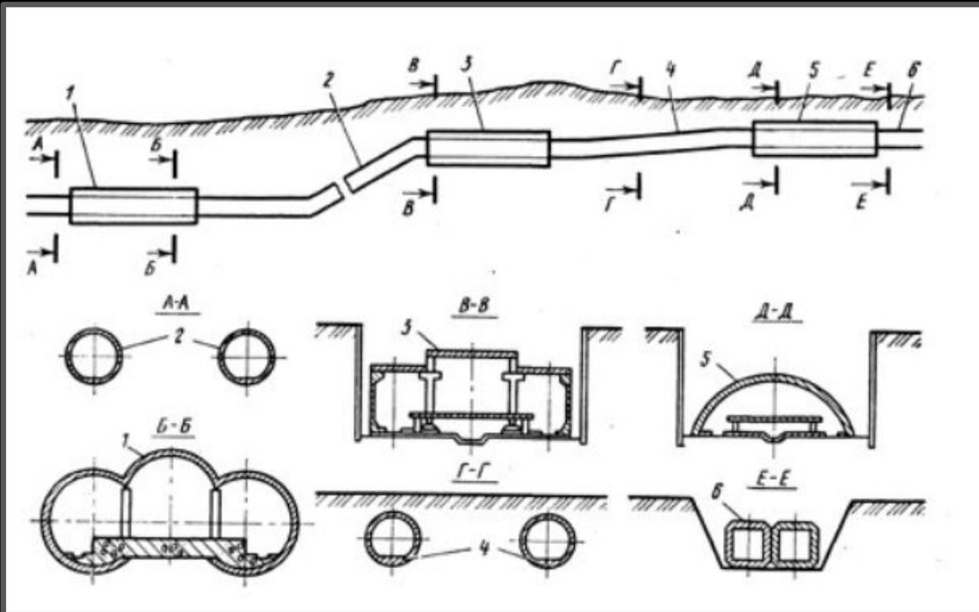
1 и 2 перегонные тоннели и станция глубокого заложения, сооружаемые закрытым способом; 3 и 5 станции мелкого заложения, сооружаемые открытым способом, 4 перегонные тоннели мелкого заложения, сооружаемые закрытым способом; 6 перегонные тоннели мелкого заложения, сооружаемые открытым способом.
