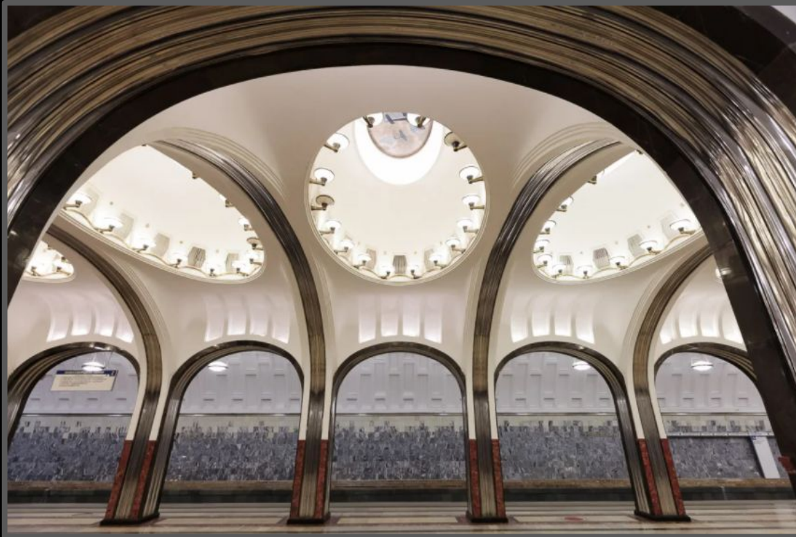
Колонная трехсводчатая Маяковская (Замоскворецкая линия) Глубина заложения 33м
