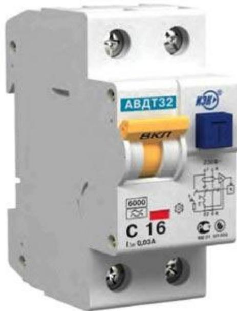
*Автомат* включается вручную, в аварийном режиме он отключается автоматически с электромагнитным или тепловым расцепителем.
