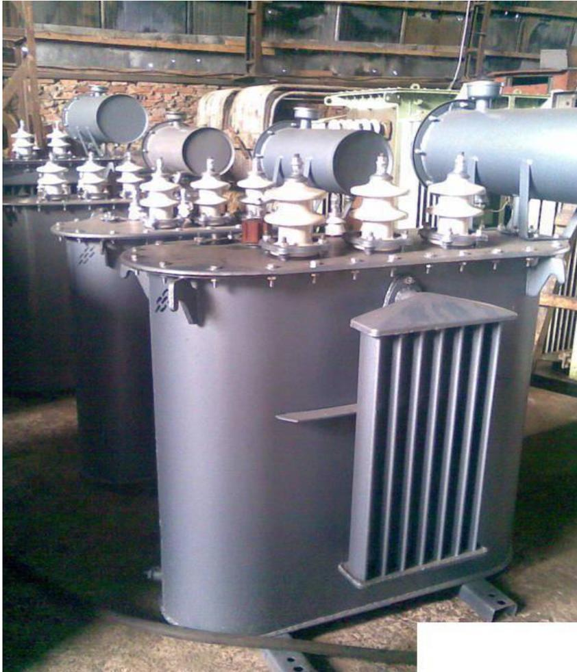
Назначение *силовых трансформаторов* — преобразование электрической энергии в электрических сетях и установках, предназначенных для приема и использования электрической энергии. В ТП используют масляные трансформаторы.
