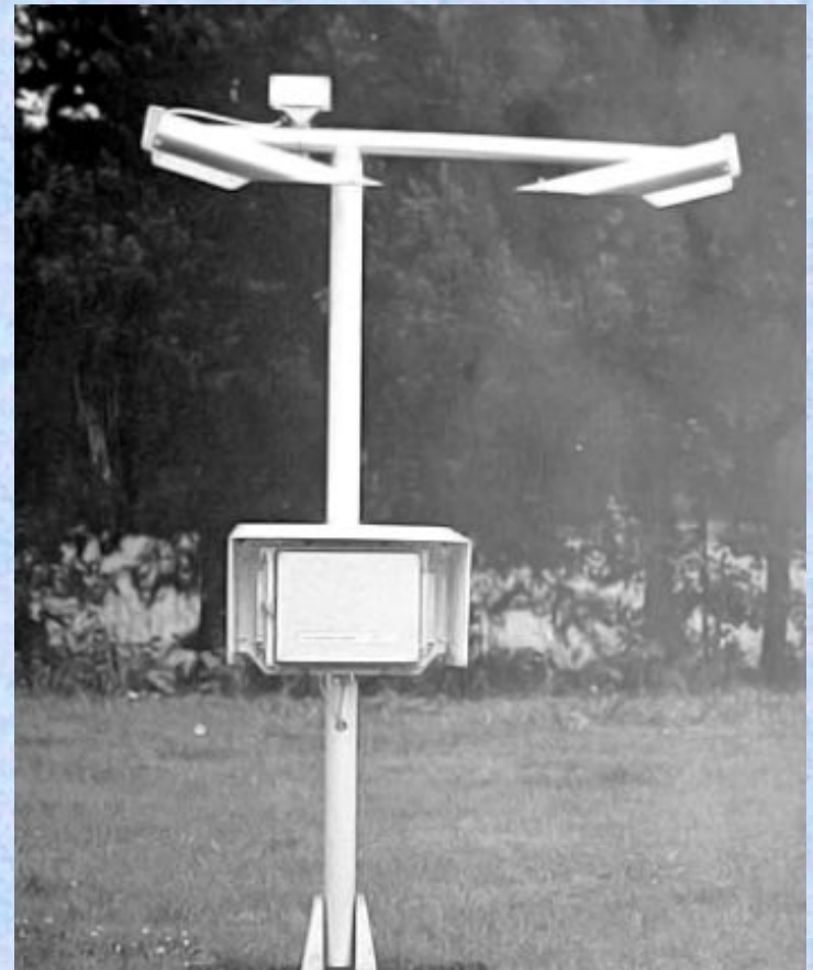
Внешний вид нефелометра FD12P
