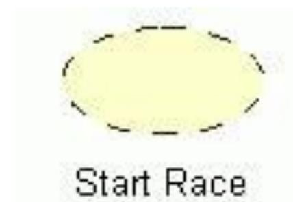
**Прецедент (Use case)** – это описание последовательности выполняемых системой действий, которая производит наблюдаемый результат, значимый для какого-то определенного **актера (Actor)**. Прецедент применяется для **структурирования поведенческих сущностей модели.**
