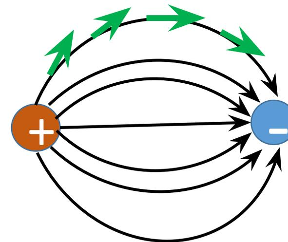
**Линия напряженности электрического поля:**
