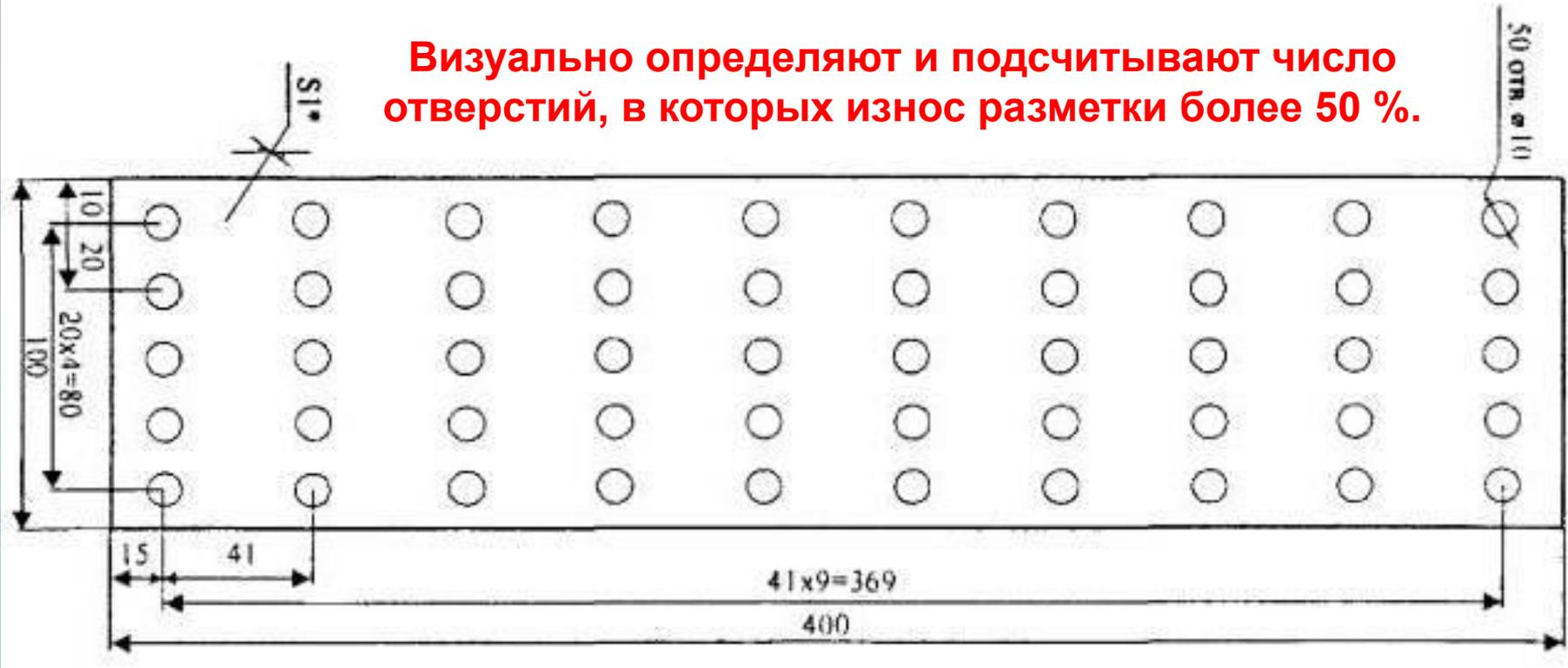
Процент износа разметки в месте измерения определяется умножением количества отверстий с износом разметки более 50 % на 2
