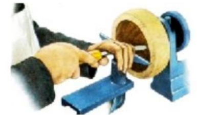
поперечное точение (торцовое, лобовое)
