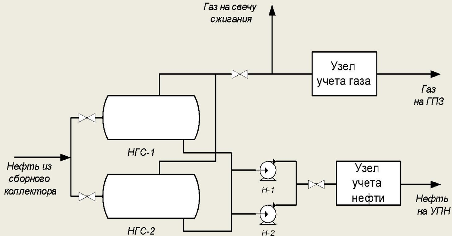
НГС-1, НГС-2 – нефтегазовые сепараторы;
