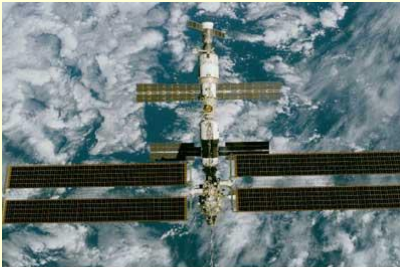
Солнечные батареи на Международной космической станции
