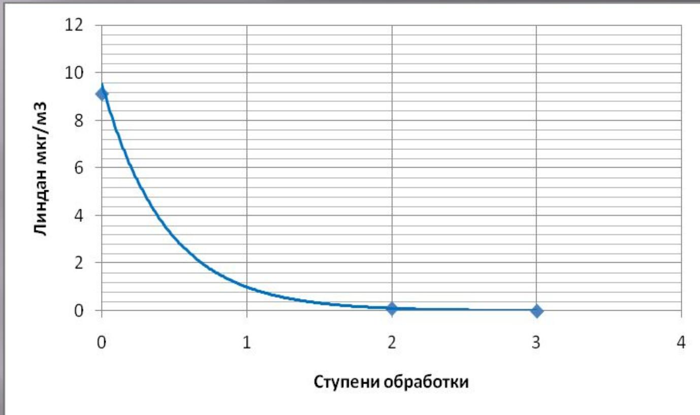
Рис. 2 Динамика уменьшения концентрации линдана на каждой ступени очистки.
