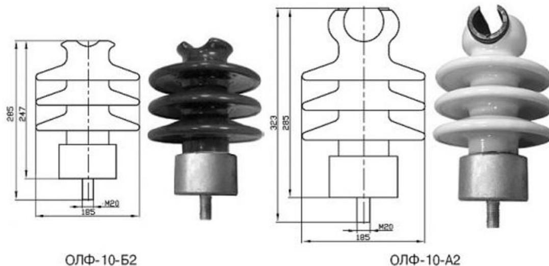
**Штыревые фарфоровые изоляторы серии ОЛФ-10 предназначены для крепления незащищенных (ОЛФ-10-Б2) и защищенных изоляцией проводов СИП-3 (ОЛФ-10-А2), на промежуточных, промежуточно-угловых и иных опорах напряжением 6 – 10 кВ.**
