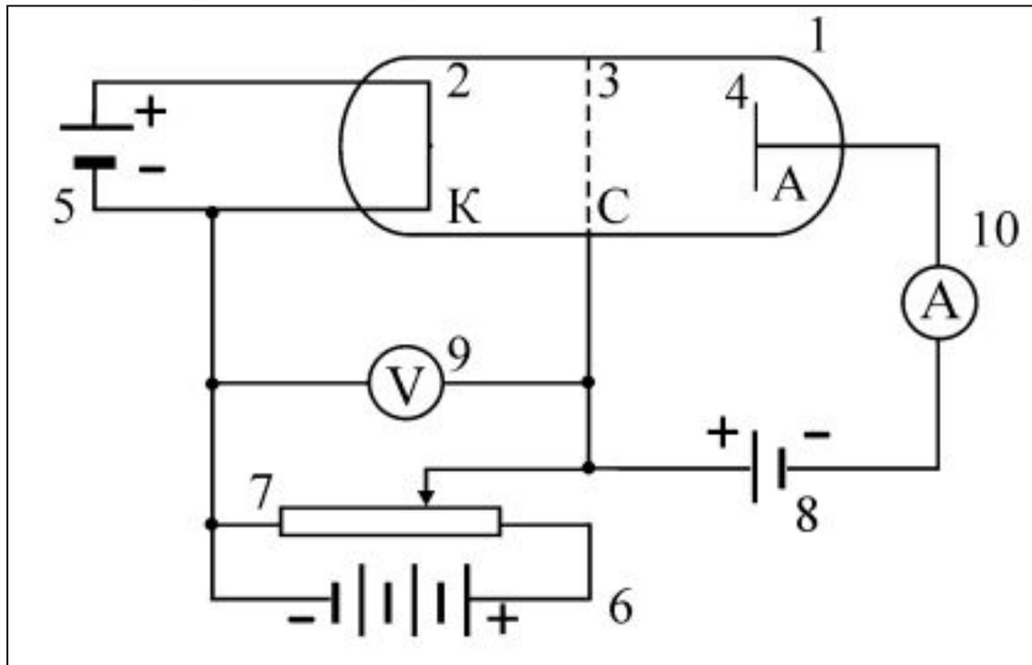
В герметичную трубку 1 помещалось небольшое количество ртути. Воздух из трубки предварительно откачивался. Внутри трубки имелось три металлических электрода:
