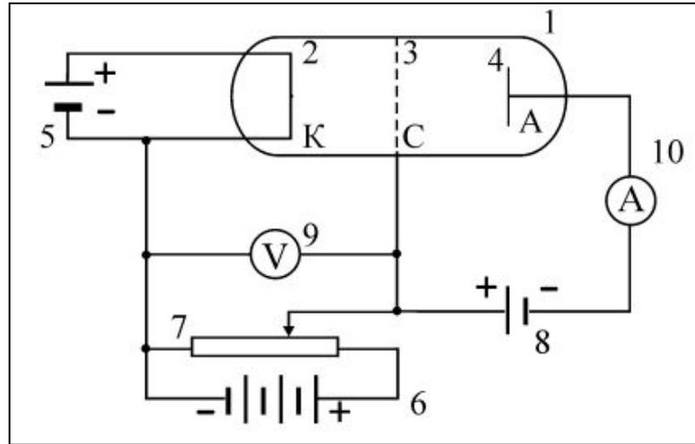
Между сеткой и анодом с помощью источника ЭДС 8 создавалось слабое электрическое поле, оказывающее тормозящее действие на электроны, пролетевшие через сетку. В процессе опыта с помощью амперметра 10 снималась зависимость силы тока анода от разности потенциалов между катодом и сеткой.
