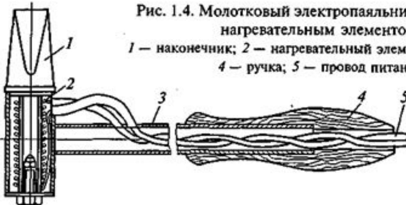
Рис. 1.4. Молотковый электропаяльник с наружным нагревательным элементом:
