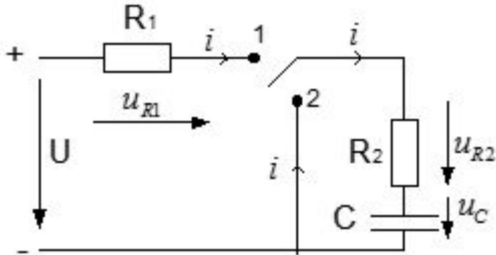
Ток разрядки конденсатора отрицательный, т.к. он направлен противоположно току зарядки конденсатора
