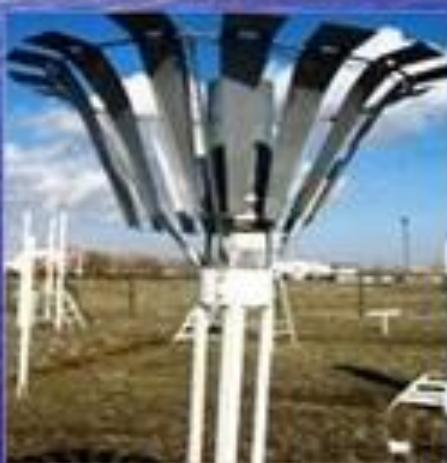
Количество выпавших осадков определяется с помощью осадкомера. Осадкомер снимают два раза в сутки. Количество осадков измеряется в миллиметрах.
