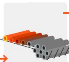
19. Навинчивание предохранительных деталей и нанесение антикоррозийного покрытия
