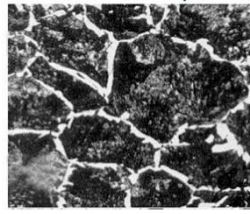
Допреэвтектоидная сталь 0,8% C (феррит + перлит) x 250
