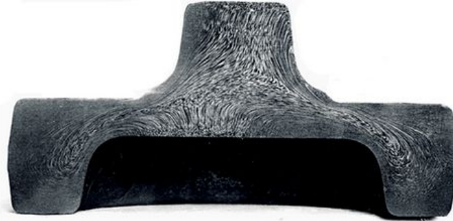
Волокнистая структура после горячей штамповки
