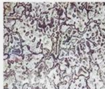
Структура сплава МЛ5
