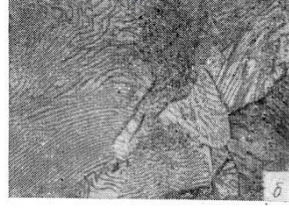
Эвтектоидная сталь 0,8% C (перлит пластинчатый) x 250
