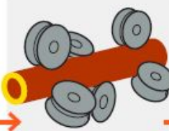
17. Навинчивание муфт и шаблонирование
