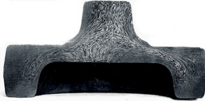
Волокнистая структура после горячей штамповки
