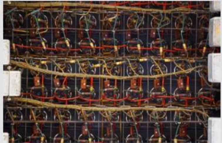
Монтаж электронных ламп на компьютерах первого поколения
