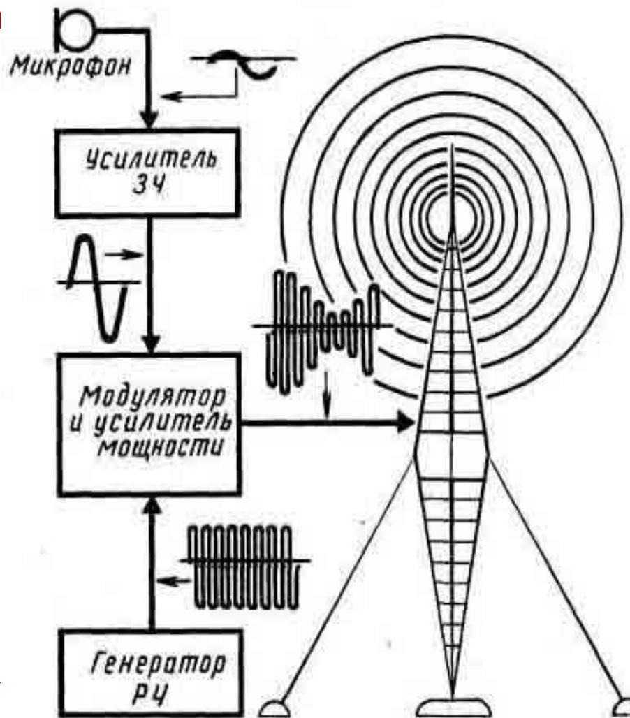
При действии звука на микрофон ток высокой частоты
